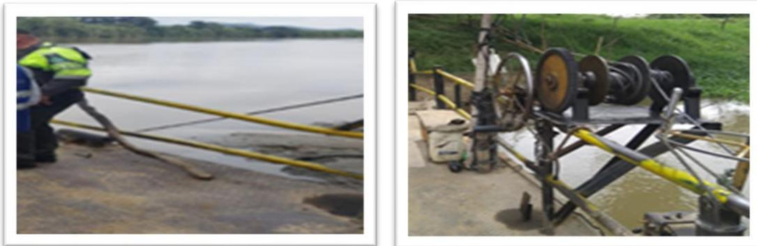
Ilustración 13. Maquinaria manual para el traslado de la barca de un lado al otro
