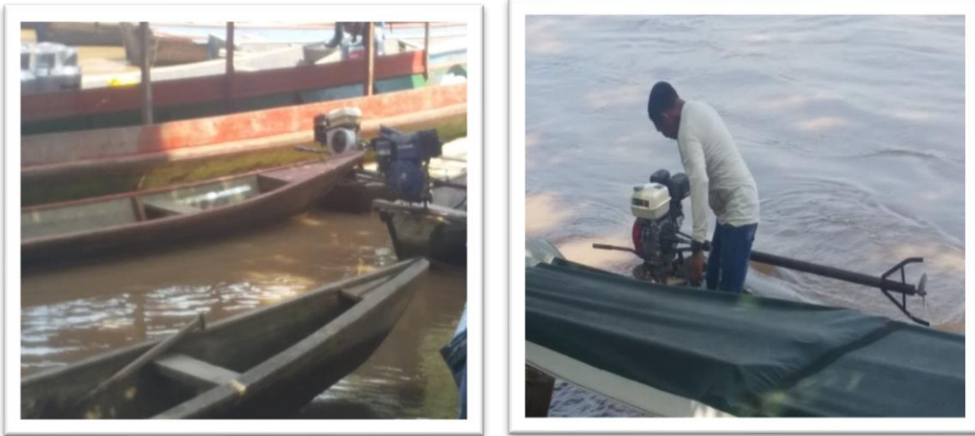
Ilustración 39. Canoas con motor de guadaña, conocidas como “peque - peque”
