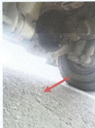
**Se evidencia el goteo continuo en la transmisión.**
