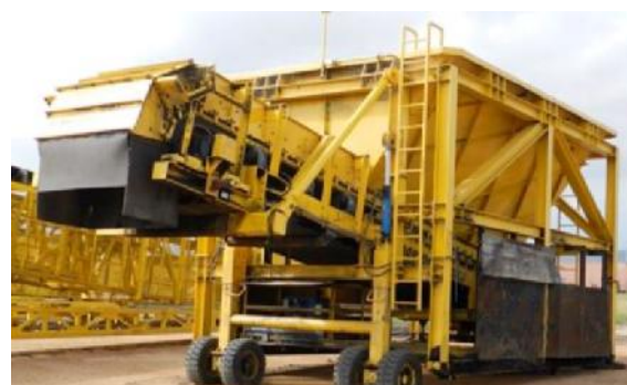
Figura 10: tolva de descargue
