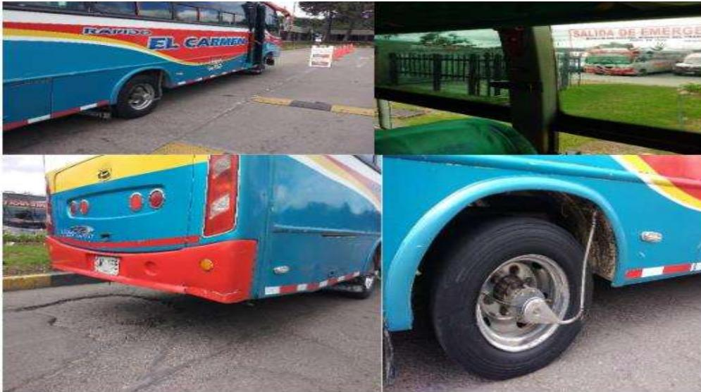
Rapido el carmen SML-958, falta martillo de fragmentacion en vidrio de salida emergencia interna, bomper roto en la parte trasera derecha, falta tuerca en perno de la llanta trasera derecha, actualizar calcomanias tanto interna como externa de
