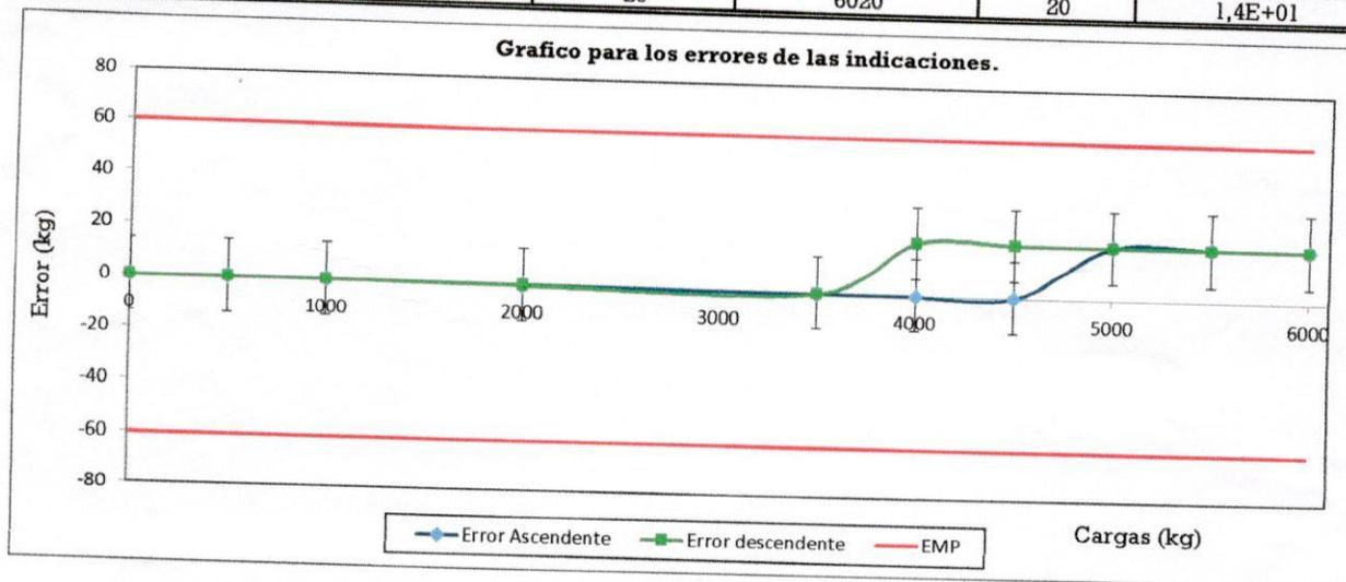
El instrumento cumple con el error máximo permitido para esta prueba
