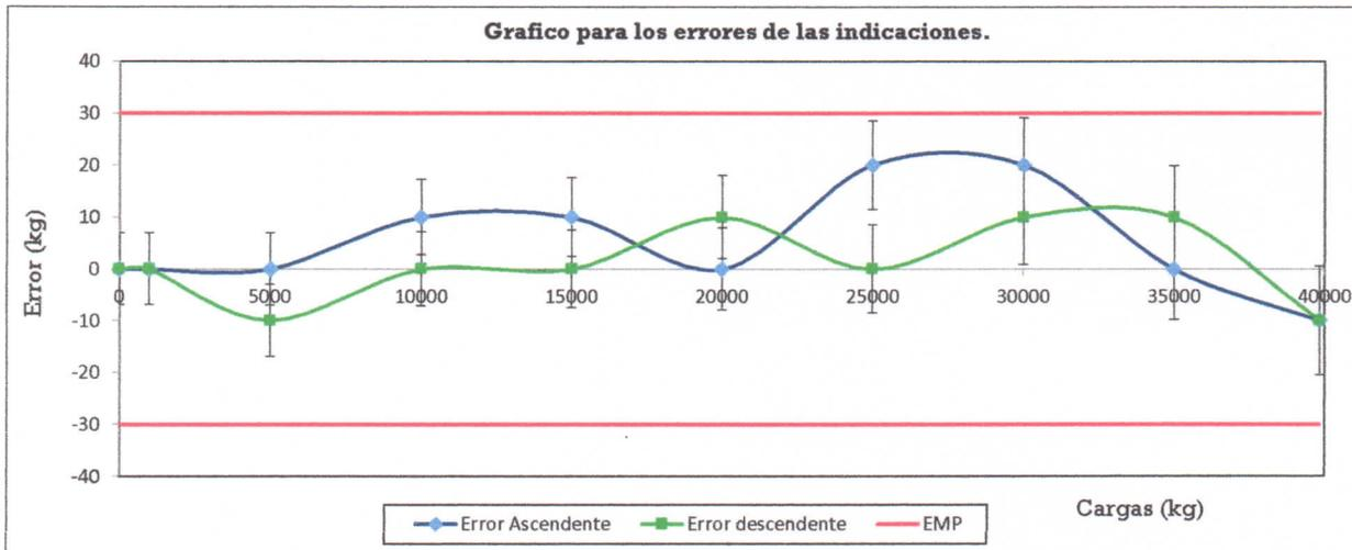
El instrumento cumple con el error máximo permitido para esta prueba
